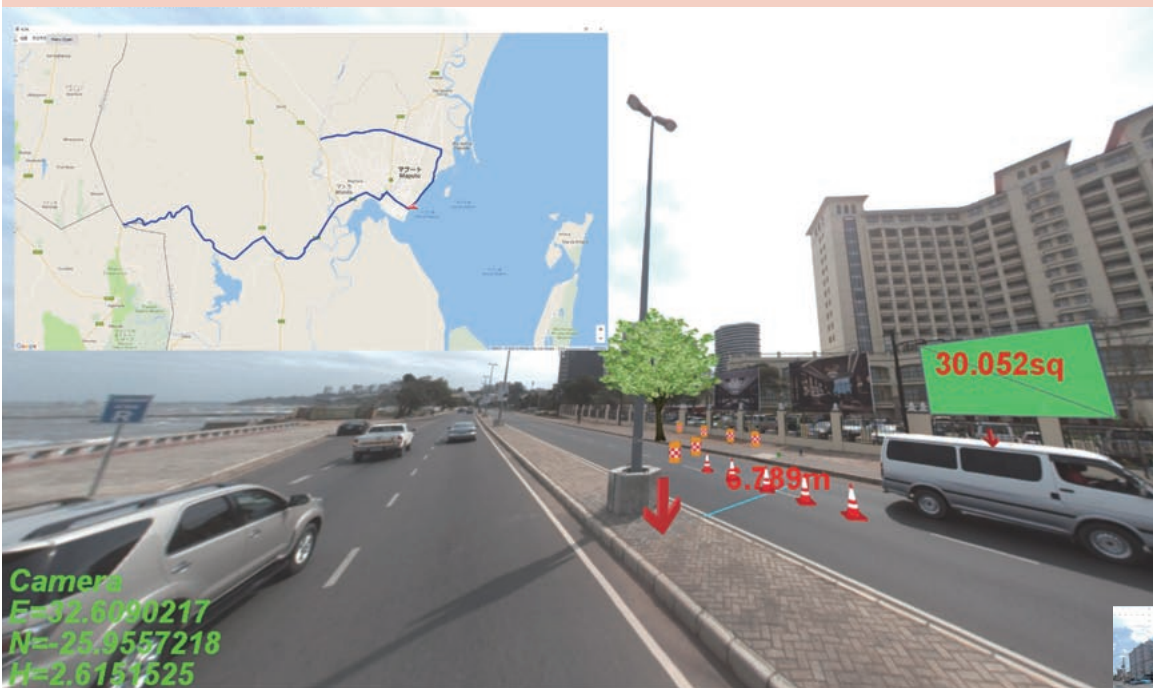
岩根研究所のシステムを使い、車で走行しながら撮影した画像を分析する。レーザーを使わないため、機材がシンプルで、輸出制限などにも影響を受けないのが強みだ
